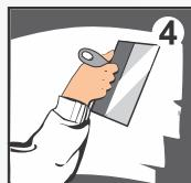
Нанесите шпатлевку в 1-2 слоя шпателем или кельмой. Второй слой нанесите не раньше, чем через 2 часа при толщине слоя до 2 мм, при более толстом слое время высыхания увеличивается. Шлифование финишного слоя производите через 2-4 часа после нанесения. Грунтование, окрашивание или другие отделочные операции производите не раньше, чем через 24 часа после нанесения последнего слоя. По окончании работы инструменты промойте водой.
